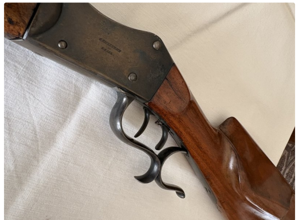
Marquage "G. RICKENBACH a BASEL" & détente double stetcher
